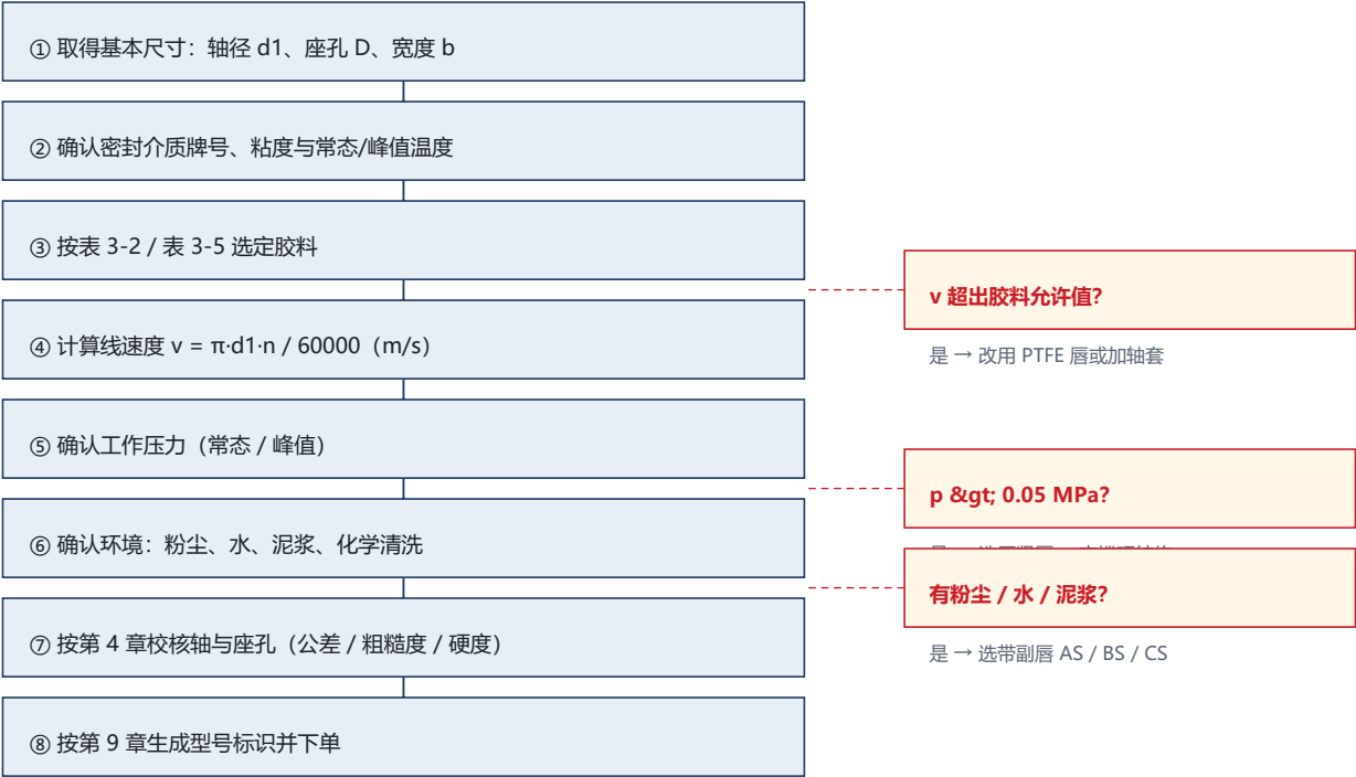
图 5-1 油封选型流程
